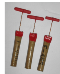
Үйкелісті тұтандырғыш - басы сияқты материалға қолданылатын абразивтік күшпен іске қосылады.
